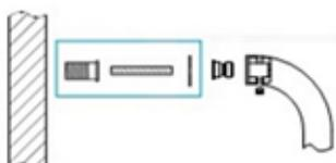
**K.18** Fissaggio singolo con bussolotto filettato, legno:
