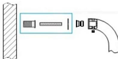
**Holz;** einseitige Befestigung mit Einschraubmutter;
