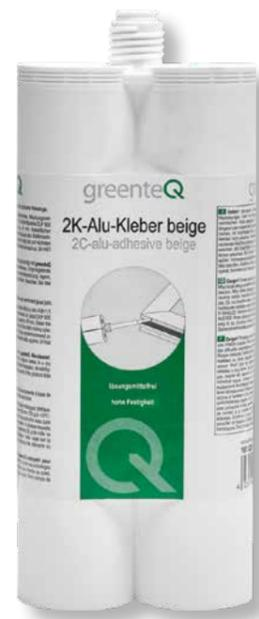
Il **greenteQ adesivo alluminio 2K** viene impiegato per l'incollaggio di angoli di porte e finestre in alluminio anodizzato e rivestito, come anche per profili per finestre, porte e facciate in alluminio. Dopo il processo d'incollaggio i profili sono verniciabili a polvere.
