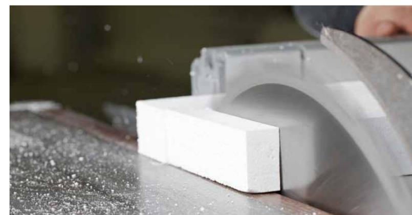
**Compacfoam** è un moderno isolante per l'edilizia. Realizzato in puro EPS, unisce resistenza e buon isolamento termico, con un peso molto basso. È un elemento flessibile ma comunque molto resistente e quindi un isolante di alta qualità. Questa combinazione lo rende in particolare economicamente interessante.
