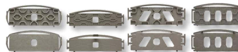
I **greenteQ Ponti di vetraggio**, costruiti in polipropilene (PP), sono adatti per sistemare i profili e servono per ottenere una superficie piana (indipendentemente dal sistema di profilo). I ponti di vetraggio formano la superficie (la base) per i tasselli per vetri, ma non li sostituiscono.
