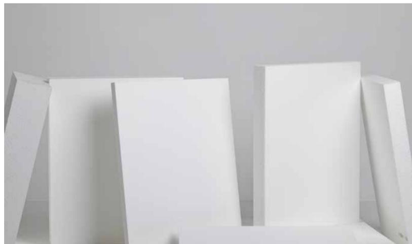
**Compacfoam** è una schiuma sintetica termoplastica con una densità di 100 - 400 kg/m<sup>3</sup> basata sul polistirene polimerico (PS). In termini di struttura fisica e chimica, corrisponde al familiare polistirene espanso (EPS, Styropor®). Piccolissime sfere di schiuma a celle chiuse con un diametro inferiore a 1 mm sono saldate termicamente e attaccate strettamente l'una all'altra per formare un blocco solido.
