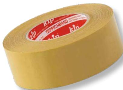
Il **nastro bi-adesivo** è un nastro in tessuto biadesivo rimovibile e resistente con uno spessore di 0,31 mm. Ha una forza adesiva bilanciata di 6,80 N/10 mm ed è particolarmente indicato per la posa temporanea di pavimenti e tappeti in fiere, convegni, ecc.
