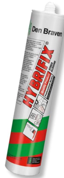
L'adesivo sigillante **DEN BRAVEN HYBRIFIX**, è un prodotto di alta qualità, monocomponente, basato su polimeri MS, inodore e privo di isocianati. Dopo l'applicazione polimerizza con l'umidità atmosferica formando una guarnizione gommosa duratura, perfettamente verniciabile con pitture acriliche e bi-componenti.
