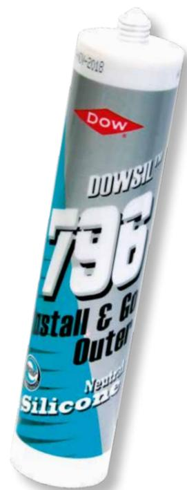
Il **Dowsil 796** è un sigillante siliconico a basso modulo a polimerizzazione neutra alcossilica per PVC, alluminio, legno, metalli e lattoneria. Permette di ottenere un' eccellente adesione su PVC, policarbonato, vetro substrati edili porosi e superfici smaltate.
