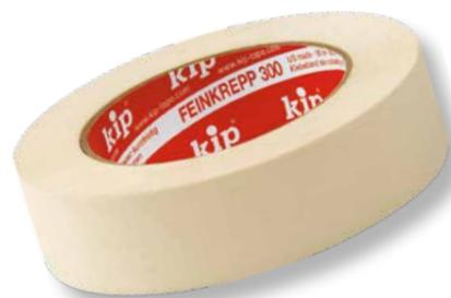
Il nastro **Feinkrepp Standard** è un nastro carta leggermente increspato con una buona forza adesiva e un'ottima resistenza allo strappo. Il nastro Feinkrepp Standard viene utilizzato principalmente all'interno per lavori di copertura a breve termine su superfici lisce. Il supporto è una crepe piatta standard impregnata con uno spessore di 0,13 mm. La colla è in gomma naturale. La durata di utilizzo all'interno è di ca. 4 giorni.
