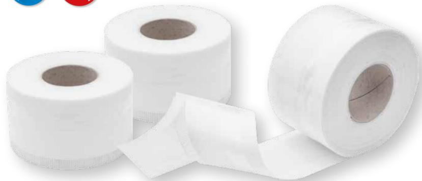
La pellicola greenteQ DUO GT plus EW per il livello di impermeabilizzazione interno ed esterno di giunti di finestre e facciate, è dotata di una griglia autoadesiva unilaterale che garantisce un fissaggio aggiuntivo durante l'intonaco, e di tre strisce autoadesive per il collegamento alla finestra.
