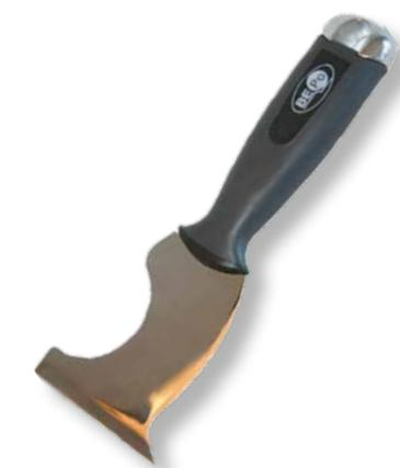
Il **raschietto BEPO Multitool** si usa per sollevare strisce senza punti di pressione col bordo largo, per rimuovere residui di stucco e vernice col bordo affilato, per tagliare giunti di silicone con la punta affilata e per sollevare coperchi di barattoli con la punta larga.
