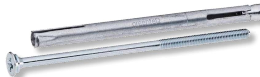
**greenteQ Tasselli metallici con testa svasata** con calotta per un fissaggio semplice ed economico di telai per porta e finestra in legno, PVC e alluminio. Si tratta di tasselli, fatti in metallo. Attraverso l'attrazione della vite, il tassello si allarga e si blocca nel foro.
