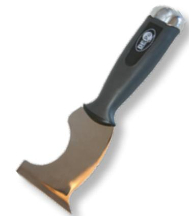
Der **Handschaber Bepo Multitool** wird zum Abhebeln von Leisten ohne Druckstellen für breite Kante verwendet, zum Abschaben von Kitt- und Farbresten mit geschärfter Kante, zum Aufschneiden von Silikonfugen mit der scharfen Spitze und zum Aufhebeln von Dosen mit der breiten Spitze.
