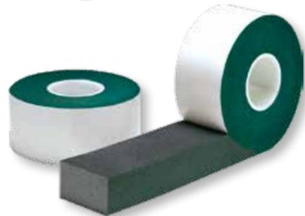
Das **greenteQ VARIO SBA** ist ein multifunktional einsetzbares Spezialfugenband mit hervorragender Funktionsfähigkeit. Es ist für die Abdichtung von Fensterbautiefen unterhalb 54 mm konzipiert und daher besonders für die Verwendung am Sohlbankanschluss (SBA) zur unteren Abdichtung im Bereich der Fensterbank geeignet. Es dient zur Luft- und Schlagregenabdichtung der Anschlussfugen mit gleichzeitigen wärmedämmenden Eigenschaften über die ganze Bautiefe.
