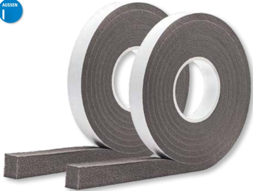
Das **greenteQ Dichtungsband 600** ist ein Fugendichtungsband aus Polyurethanweichschaum mit Acrylatdispersionimprägung, Hilfs- und Füllstoffen. Es ist eine Komponente des 3-Ebenen-Fugenabdichtungssystem.
