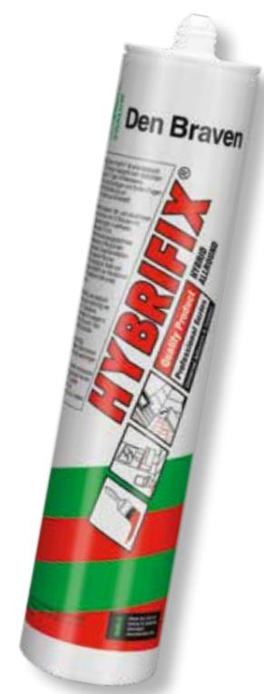
**Den Braven Zwaluw Hybrifix** ist ein starker, hybridbasierter Polymer Konstruktionskleb- und Dichtstoff. Er ist geruchlos, neutral und frei von Isocyanaten. Nach dem Auftragen härtet das Produkt mit Luftfeuchtigkeit aus und ist nach vollständiger Trocknung mit Farben auf Wasserbasis und zwei-komponentigen Farben perfekt überstreichbar.
