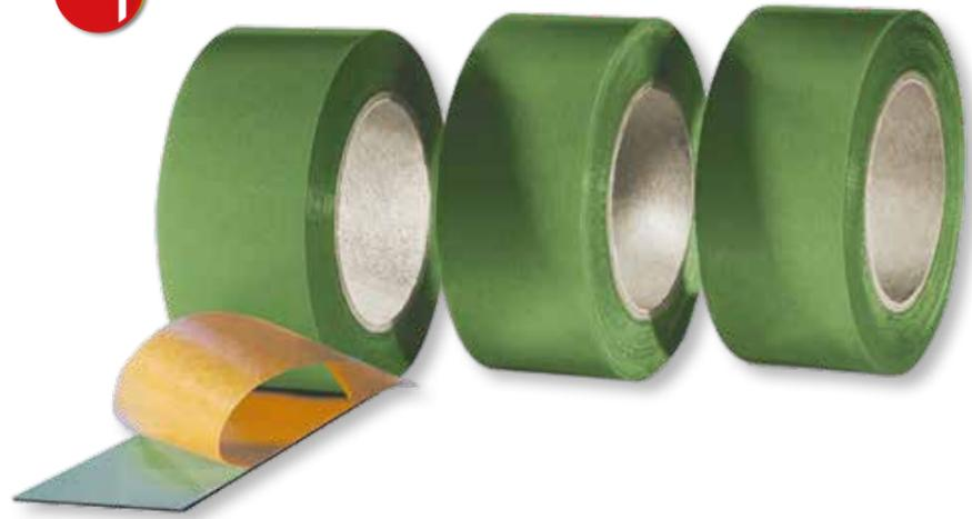
**ISO-TOP FLEXBAND** ist eine mit einem sehr haftstarken Acrylatdispersionskleber einseitig ausgerüstete LDPE-Folie. **ISO-TOP FLEXBAND** ist zur Komplettabdichtung gemäß DIN 4108-7 geeignet. Es ist für die zuverlässige Verklebung von Dampfbremsschichten auf der Basis von Folien, Vliesen und Papier geeignet und stellt eine sichere Verbindung zwischen Folie und Untergründen wie z. B. Beton, Ziegelmauerwerk her.
