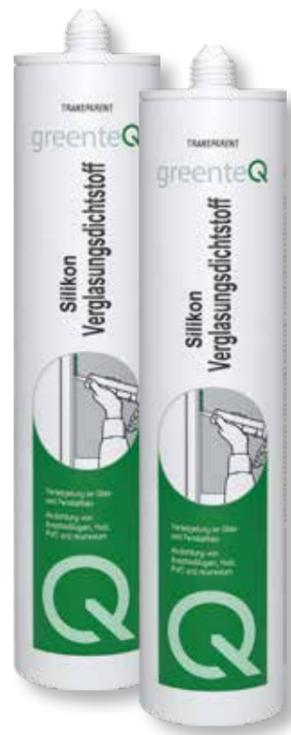
temperaturunabhängigkeit (-50°C bis +180°C) aus. Der **greenteQ Verglasungsdichtstoff** ist speziell für die Fenster- versiegelung, die Anschlussfuge und andere Bewegungsfugen geeignet. Er bietet eine dauerhafte und gute Haftung ohne Primer auf den meisten in Bau und Industrie vorkommenden Materialien wie Glas, Aluminium, glasierten Fliesen, Polyester, Messing, Stahl, behandeltes Holz, PVC, VSG (Verbund-Sicherheits-Glas).
