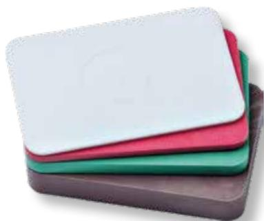
Die **greenteQ Unterlegplatten** sind massive Vollguss-Platten, gefertigt aus Polypropylen (PP). Durch die Materialeigenschaften von Polypropylen erfüllen die greenteQ Unterlegplatten bereits die Vorgaben zur Randverbundverträglichkeit. Die **greenteQ Unterlegplatten** werden hauptsächlich zum Ausgleichen und Ausrichten im Fenster- und Türbau eingesetzt. Daneben finden sie Anwendung im Innen- und Trockenausbau oder können universell als Distanzplatte oder Unterlegplatte verwendet werden.
