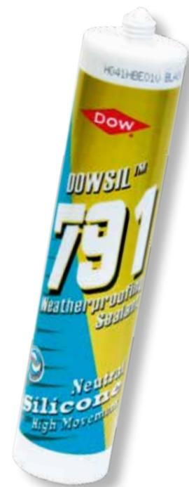
Der **Dowsil 791** Weatherproofing Sealant, witterungsbeständige Silikon-Dichtungsmasse, ist ein 1-komponentiger, neutral vernetzender Silikondichtstoff mit niedrigem Modul und wurde speziell für die Wetterabdichtung und Verglasungen von Baufassaden entwickelt.
