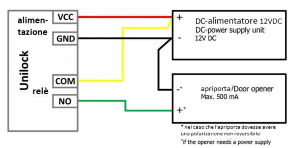
**ATTENZIONE:** Fare ora un test elettrico e assicurarsi che il sistema è funzionante. Verificare che l'Unilock sia alimentato ed eseguire una prova di apertura. Controllare che l'apriporta si sblocca.
